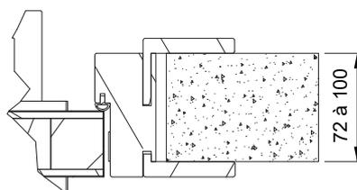
Avec Kit Extension cloison > 100 mm
