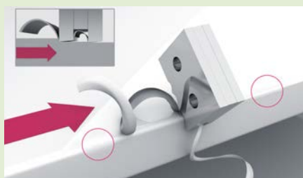
2 e étape : un racleur double pour des géométries parfaites
