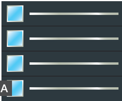
Modèle A : • 4 motifs plats : 30 x 1500 mm • 4 hublots collés ABA carrés vitrage composite glace PMMA sablé : 300 x 300 mm
